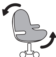
MECANISMO SINCRONIZADO: El respaldo y el asiento se adaptan de forma sincronizada pero en distinto ángulo, a los movimientos de la persona sentada.
