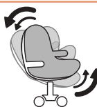
MECANISMO ASINCRONIZADO: El respaldo y el asiento se adaptan de forma independiente a los movimientos de la persona sentada. Permite una mejor adaptación al cuerpo.
