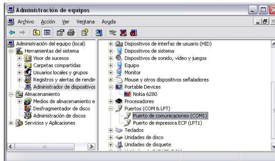
Seleccione el puerto serie utilizado dentro del grupo *Puertos(COM y LPT)* y confirme que la configuración es correcta. Fíjese en que la velocidad de transmisión (Bits por segundo) sean los establecidos en baudios en el programa y el terminal.
